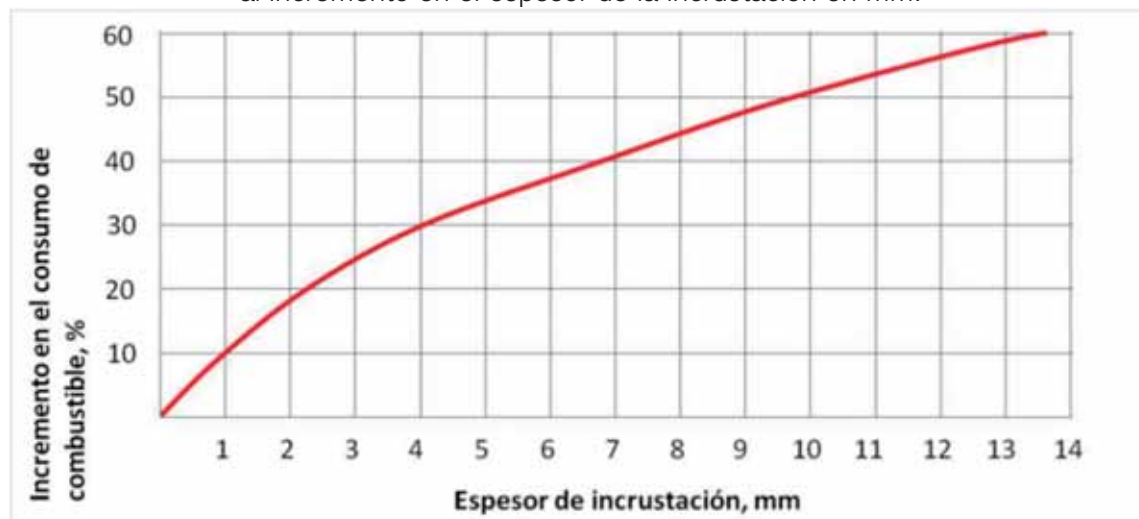
Gráfica 6. Curva de incremento en el consumo de combustible respecto al incremento en el espesor de la incrustación en mm.
